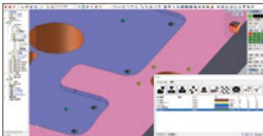
規格が明確でない3D形状に対して、穴加工の種類など、具体的に加工方法を定義直すことができ、より正確な見積作成を行います。
