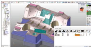
面の色により、加工の種類や、加工精度を設定することができ、指定された加工工程で算出することが可能です。
