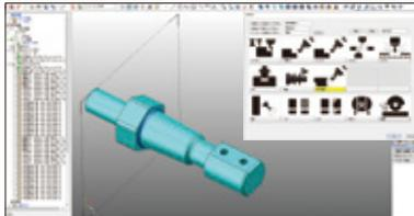
5軸MC、複合旋盤など、複合機に対応、加工方向を自動認識し、見積作成します。通常の機械との段取り時間のロスも集計します。
