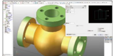
フィーチャ認識の基本設定として、部品加工、プレート加工、金型のキャビ・コア加工、鋳物と別々に用意することで、より業種にあった認識で加工を行います。
