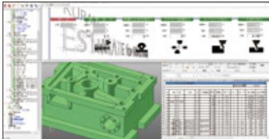
3Dモデルから、フィーチャ認識を行い、加工を割り当てます。加工時間、その他の工程を算出し、見積を作成します。
