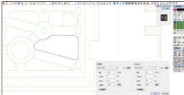
2D図面から加工形状の指定や、穴加工を認識し、工程の割り当て、加工時間を算出します。
